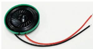
電圧をかけることで、音が鳴る電子部品です。ブザー内部の圧電振動板(電圧で伸縮する板)に、電圧をかけることで音が鳴ります。
