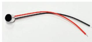
音声を入力することで、電圧が変化する電子部品です。電圧の変化を信号として取り出すことで音声をデータとして扱うことができます。
