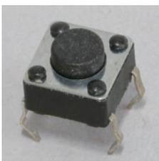
ボタン(スイッチ)は用途によって様々な種類があります。タクトスイッチは押し続けている間だけ電気を流すことができる電子部品です。
